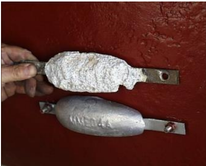
Anodeblok van zink in de scheepsbouw
